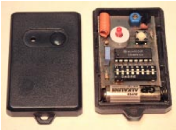
Figura 1. Unidad de control remoto tradicional
