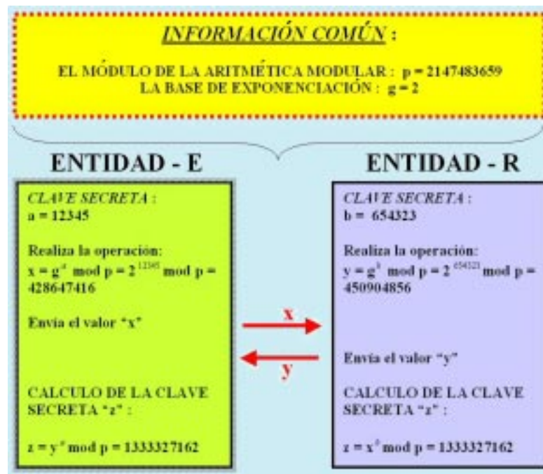
Fig. 2.- Esquema de un mecanismo de distribución de una clave secreta "z" compartida, estilo D-H (Diffie-Hellman), entre dos entidades finales (entidad emisora E y entidad receptora R) utilizando un canal de comunicaciones no confidencial pero autenticado.
