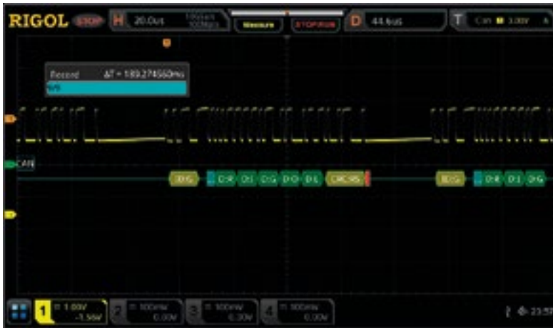
Figura 3. Uso de la función de grabación con 9 frames por 100 Mpts (900 Mpts) con decodificación CAN-H.
