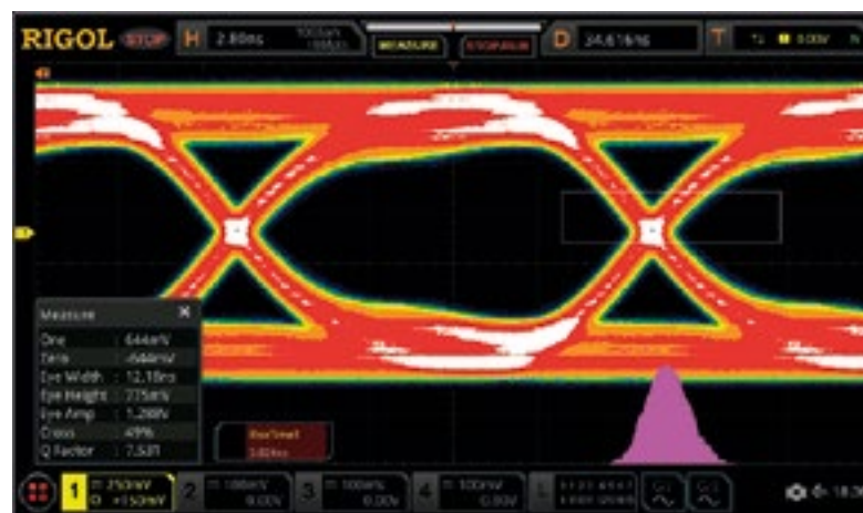
Figura 4. Medición del diagrama del ojo con un histograma de una transmisión de señal digital.
