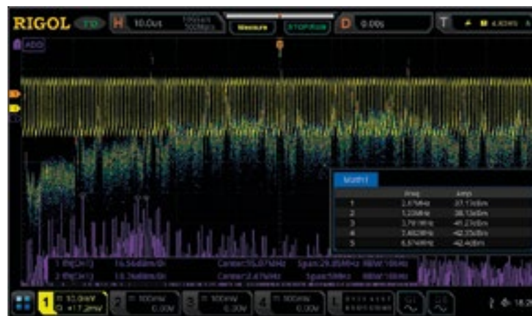
Figura 8. Pantalla FFT diferente (púrpura: rango de frecuencia completo; pantalla de ajuste: rango ampliado).
