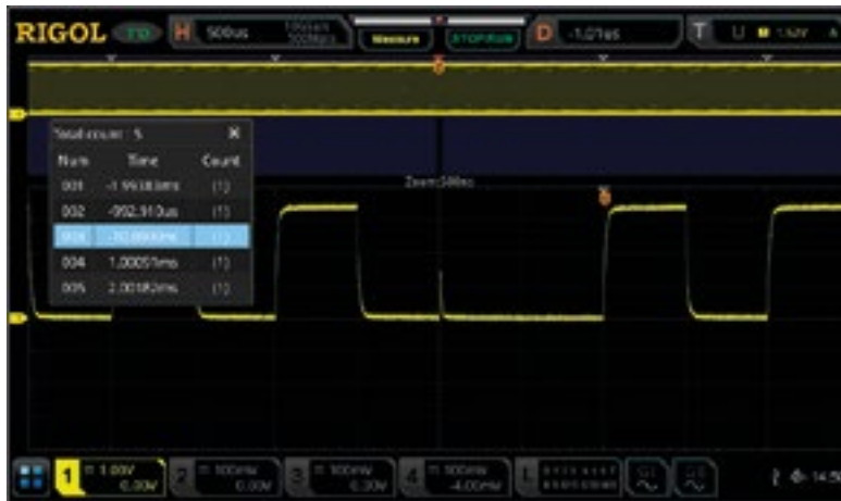
Figura 5. Función de búsqueda de los fallos individuales, que se pueden ver con más detalle utilizando el zoom.
