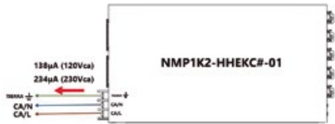
Figura 1. Corriente de fuga a tierra 138\mu\text{A} ( 120\text{Vca} ) y 234\mu\text{A} ( 230\text{Vca} ).
