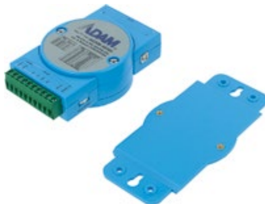
Figura 1. Convertidor ADAM-4520-EE de Advantech se puede conectar fácilmente a varios dispositivos.
