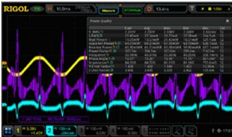
Figura 7. Medición de un suministro de CA con la función de análisis de potencia.
