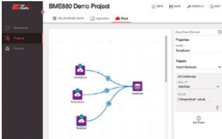
Figura 9. En la pestaña de la nube DK IoT Studio, los desarrolladores definen las operaciones basadas en la nube, como el almacenamiento en la nube de los datos de los sensores. (Fuente de la imagen: Digi-Key Electronics).
