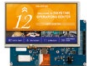
RFF70VA2-11W-DHS Con Touch panel Resistivo con interface USB.
