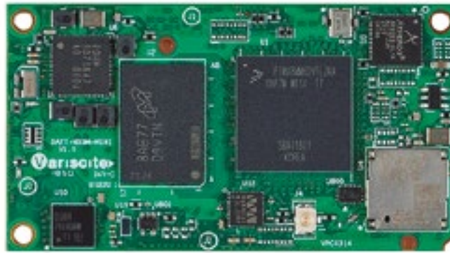
Figura 2. Sistema en módulo i.MX 8 Mini de Variscite.
