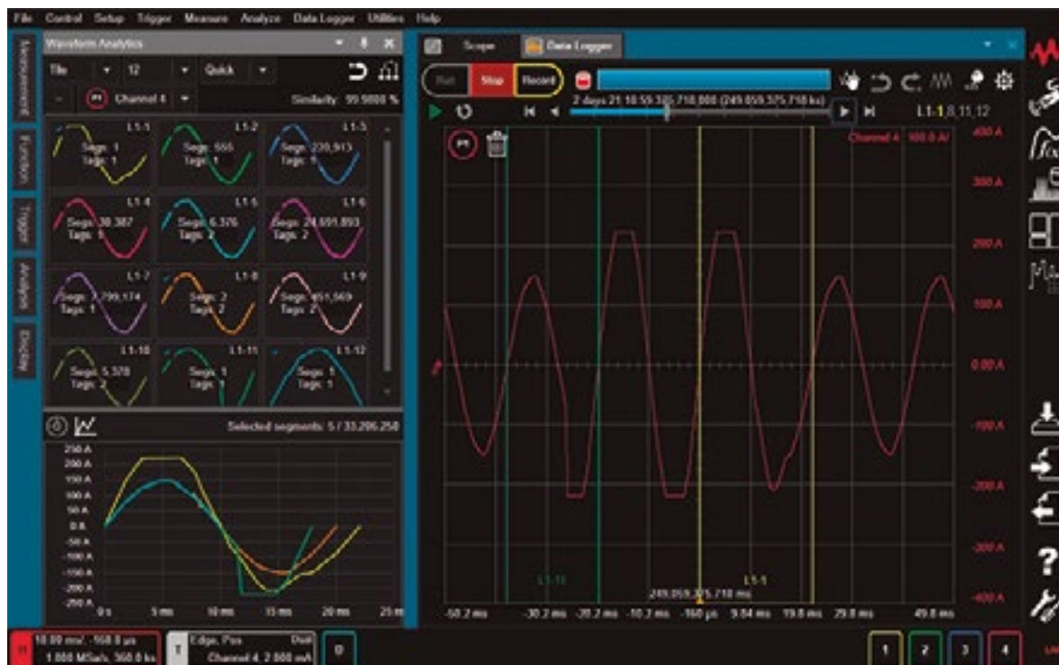
Figura 2. Anomalías de sobretensión detectadas en la tensión de la línea eléctrica comercial.
