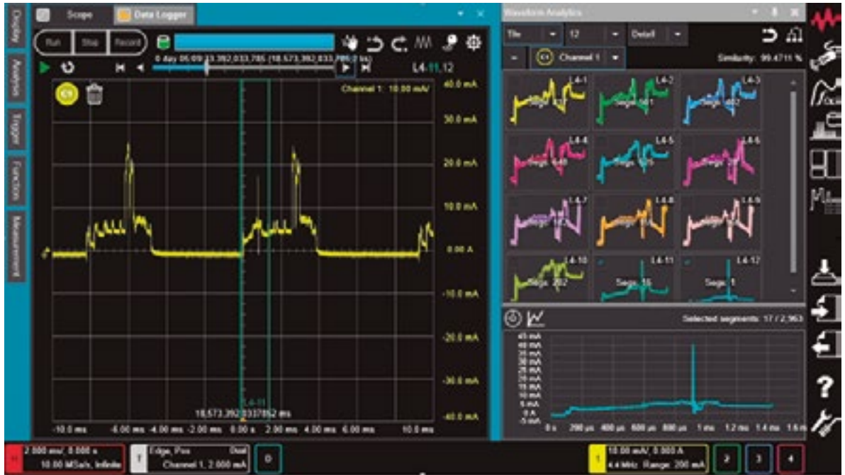
Figura 3. Formas de onda con picos elevados tuvieron lugar 17 veces entre más de 7 millones de segmentos de formas de onda identificadas en un período de 5 minutos en un dispositivo IoT.
