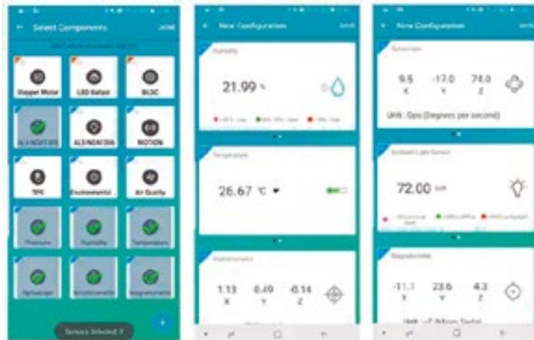
Figura 6. La aplicación móvil RSL10 Sense and Control de ON Semiconductor proporciona una solución lista para evaluar el rendimiento de los numerosos sensores de la placa de evaluación RSL10-SENSE-GEVK. (Fuente de la imagen: ON Semiconductor).
