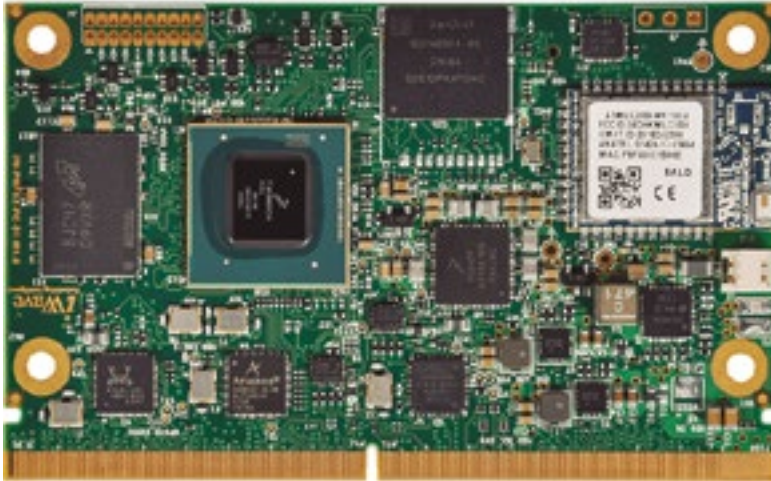
Figura 3. Sistema en módulo i.MX 8 basado en iWave SMARC.
