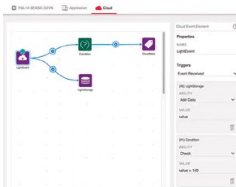
Figura 11. DK IoT Studio admite operaciones más sofisticadas en la nube y en la aplicación móvil, como esta verificación de condición para establecer metadatos de estado de la aplicación y preservar los datos en el almacenamiento en la nube. (Fuente de la imagen: Digi-Key Electronics).
