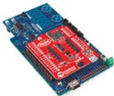
Figura 2. El shield adicional de PSoc Pioneer IoT (tablero rojo) extiende las capacidades de los tableros Cypress Pioneer como el Kit PSoc 6 BLE Pioneer (azul) con sus opciones de múltiples conectores para añadir los tableros compatibles con Qwiic y XBee disponibles. (Fuente de la imagen: SparkFun Electronics).
