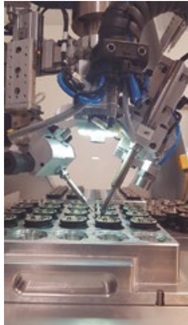
4. La telecámara con corona de LEDs.
