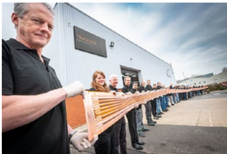
Figura 3. Circuito impreso flexible multicapa de 26 m de longitud para un vehículo aéreo no tripulado.
