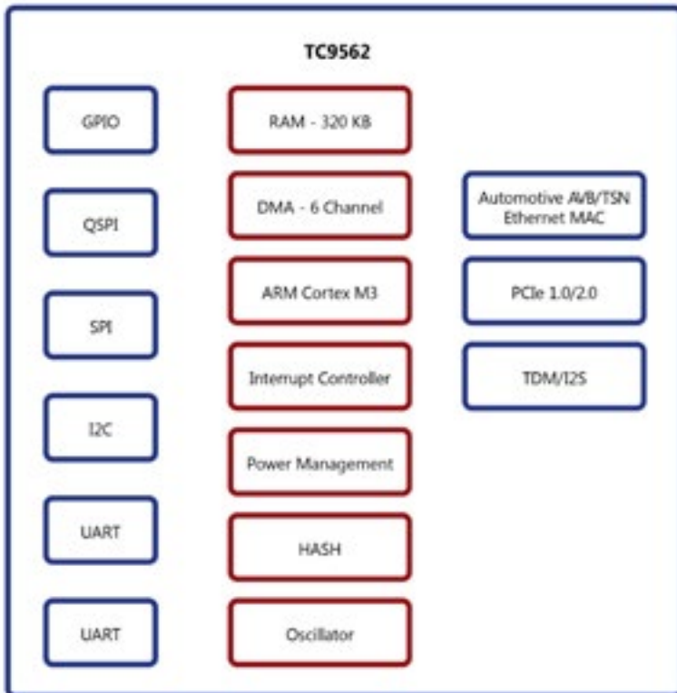
Figura 2. Diagrama de bloques del TC9562 que muestra la amplia gama de periféricos, MAC Ethernet para automoción y el núcleo de procesamiento Arm Cortex-M3.
