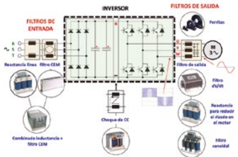
Figura 10. diversas soluciones de filtrado en la entrada, en el bus de corriente continua y en la salida del inversor.
