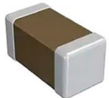
Figura 4. El GCM1885C2A101JA16 es un capacitor de montaje superficial de cerámica de clase 1, 100 pF con una tolerancia del 5% y una capacidad de 100 voltios. (Fuente de la imagen: Murata Electronics).
