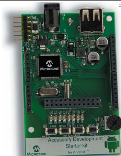
que permite la comunicación directa entre las aplicaciones y un accesorio conectado al Smartphone o al tablet, vía USB
