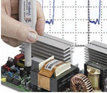
La medida resultante puede incluir otros efectos de campo cercanos a la punta de la sonda que no vengan directamente del conductor. Puede incluir efectos de DC desde componentes magnetizados adyacentes y desde campos magnéticos de tierra, más efectos AC de transformadores y otras fuentes de radiación.
