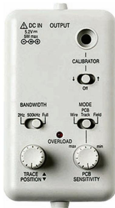
La I-prober 520 consiste en propia sonda conectada por un cable de 1,5m a una caja de control. Esta a su vez tiene una salida de 0,5m acabado en BNC para conectar a cualquier osciloscopio.
