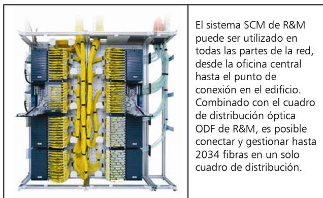
Es posible configurar el ODF con módulos de empalme, módulos de parcheo y módulos combinados, que se montan empleando una técnica de instalación rápida y sin herramientas. Una unidad ODF puede gestionar hasta 2034 fibras. El sistema garantiza un radio de curvatura máximo de 40 mm, lo que constituye un factor decisivo para una administración de fibras fiable y sin
