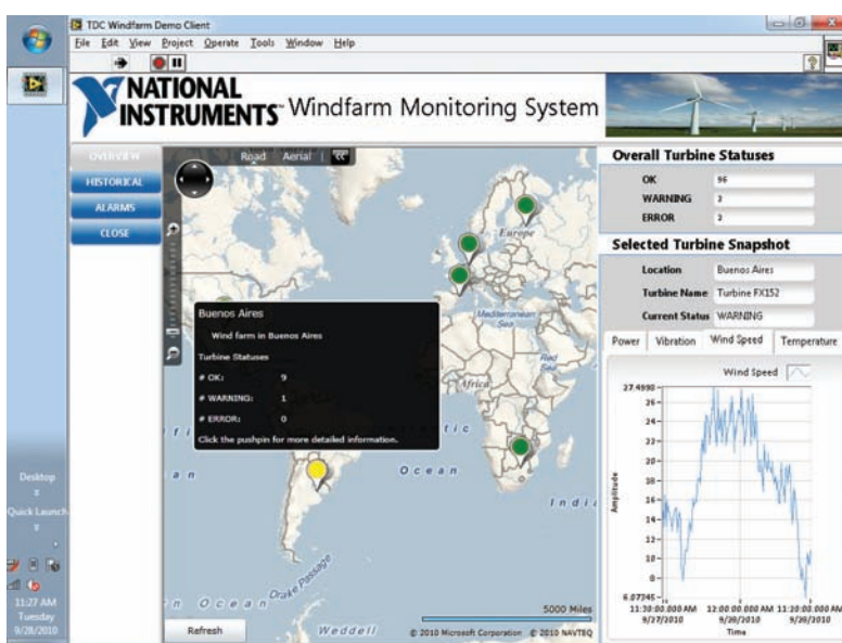
Figura 2. Visualización de las localizaciones globales de parques eólicos remotamente supervisados usando un sistema de adquisición para su supervisión junto con un sistema de almacenamiento basado en la nube . Los datos agregados se almacenan en una localización escalable central y pueden ser utilizados por cualquier usuario autorizado.
