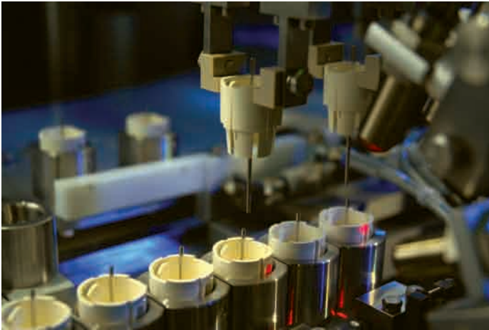
Sortimat enfoca el rendimiento global, por ejemplo en el sistema de montaje de inhaladores multiuso de líquido sin gas propulsor.
