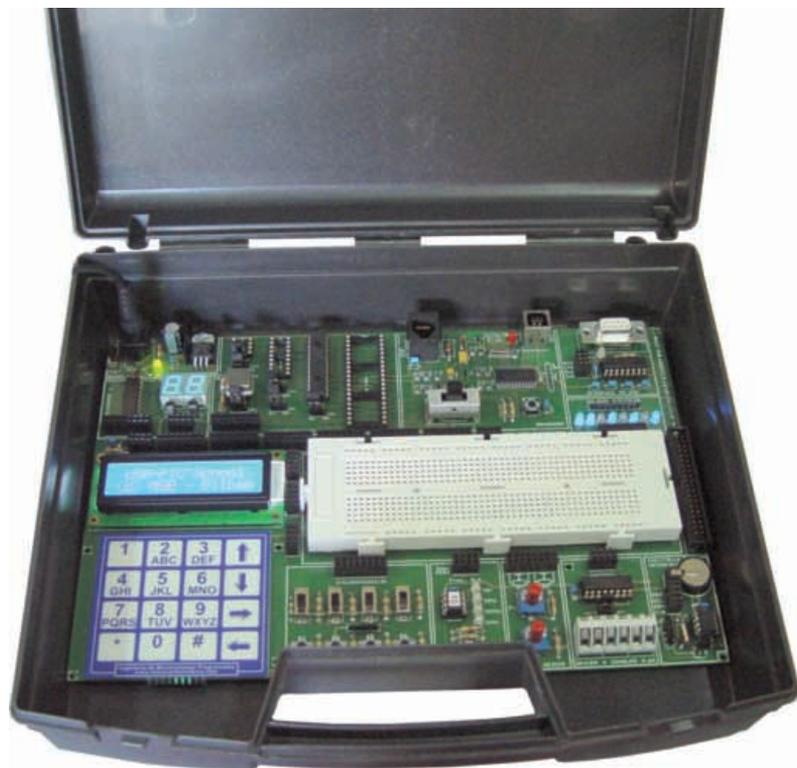
Figura 1. Fotografía del USB-PIC'School en el maletín de transporte y almacenamiento.
