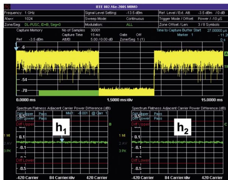
Figura 3. Resultados de medida para aplicaciones MISO: Este analizador muestra medidas adicionales como la planicidad espectral de los dos canales h1 y h2.
