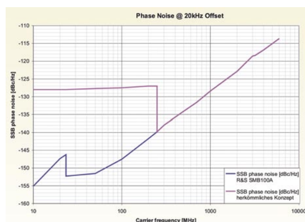
Figura 5. Ruido de fase SSB a 20 kHz de offset: R&S SMB100A comparado con diseños convencionales.
