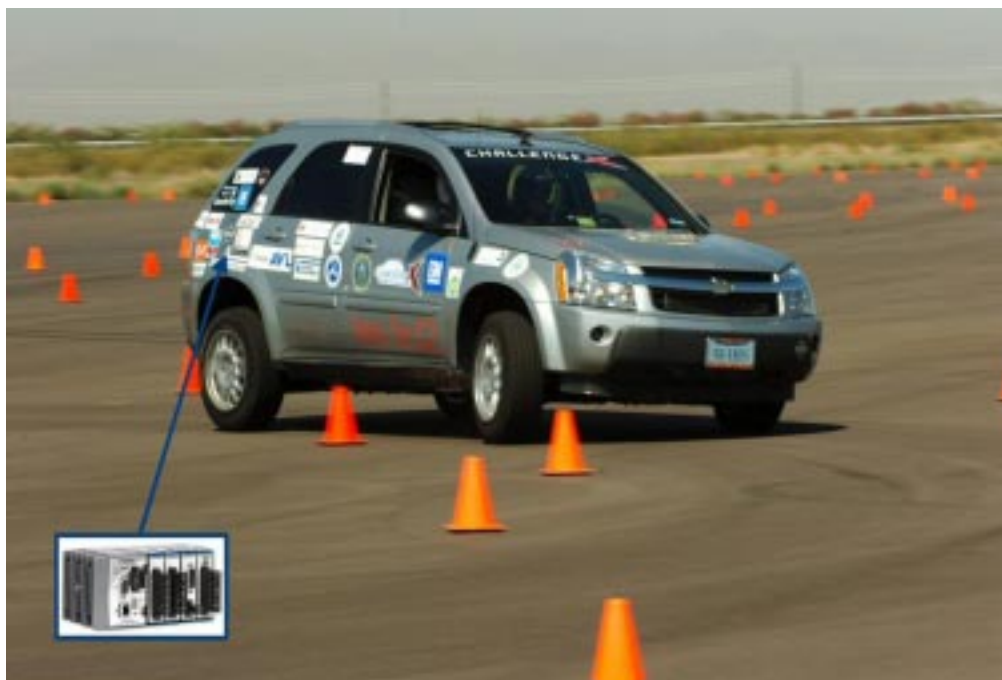
Figura 3. El vehículo híbrido de Virginia Tech compete en el 'GM Proving Grounds' en Mesa, Arizona. El controlador del vehículo de CompactRIO está embebido en hueco de la rueda posterior del vehículo. (foto cortesía de Roy Feldman/Challenge X).
