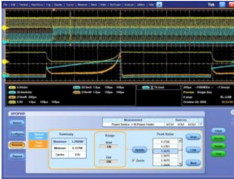
Figura 7. Resultado de la utilización del 'HiPower Finder'. Se muestra la forma de onda de potencia en el dispositivo de conmutación cuando la carga cambia.
