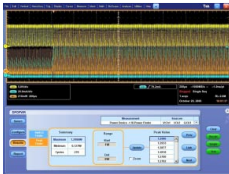
Figura 6. Pérdidas de potencia mínimas, máximas y medias durante un cambio en la carga
