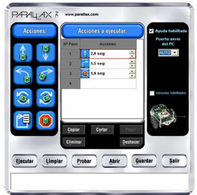
Figura 4.- Ventana de trabajo del programa GUI Bot para programar todas las acciones y movimientos del robot Home Boe Bot.
