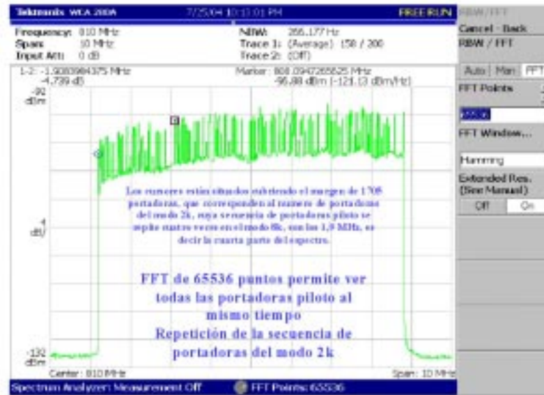
Figura 26. Detalles del centro de un espectro DVB-T en el modo 8k
