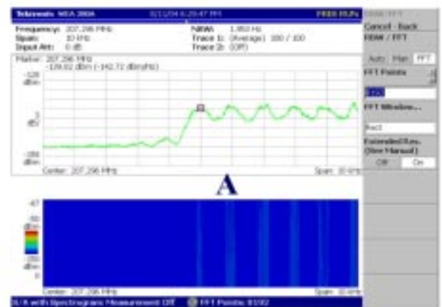
Figura 36. La señal DAB no tiene portadoras piloto
