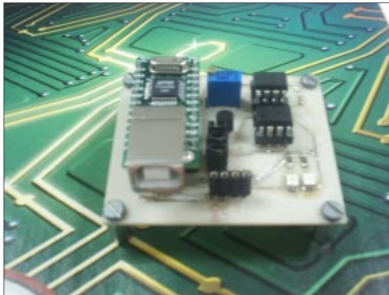
Figura 4. Fotografía del prototipo con interfaz USB
