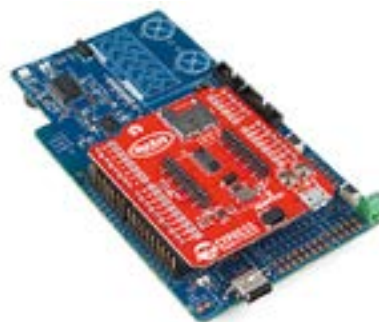
Figura 2. El shield adicional de PSoC Pioneer IoT (tablero rojo) extiende las capacidades de los tableros Cypress Pioneer como el Kit PSoC 6 BLE Pioneer (azul) con sus opciones de múltiples conectores para añadir los tableros compatibles con Qwiic y XBee disponibles. (Fuente de la imagen: SparkFun Electronics).
