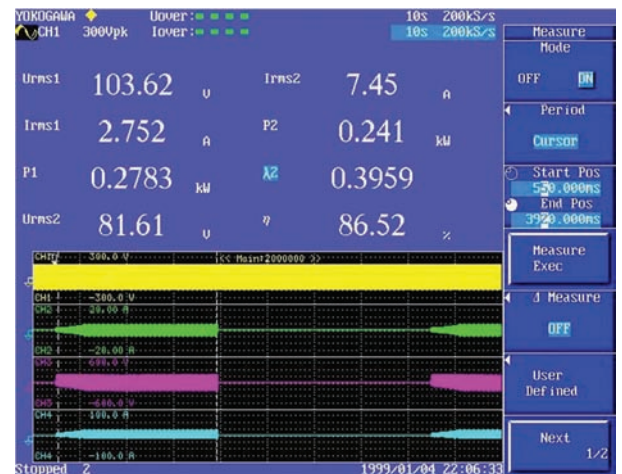
Medida de potencia de una cocina de inducción con el analizador de potencia PZ4000
