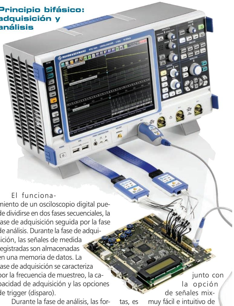
El funcionamiento de un osciloscopio digital puede dividirse en dos fases secuenciales, la fase de adquisición seguida por la fase de análisis. Durante la fase de adquisición, las señales de medida registradas son almacenadas en una memoria de datos. La fase de adquisición se caracteriza por la frecuencia de muestreo, la capacidad de adquisición y las opciones de trigger (disparo).
