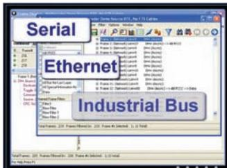
El Netdecoder de Frontline Test Equipment es un analizador de comunicaciones especializado en los protocolos comúnmente usados en automatización y SCADA. Está compuesto por software ejecutable bajo Windows y adaptadores de hardware según el tipo de red a analizar: serie (RS-232/RS-422/RS-485), Ethernet o buses especializados tales como DeviceNet, ControlNet, Allen-Bradley y CAN 2.0A.
