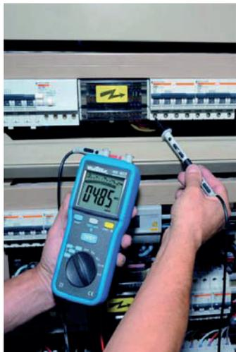
El controlador de aislamiento MX 407 es un equipo utilizado principalmente para verificar la seguridad de las instalaciones eléctricas.
