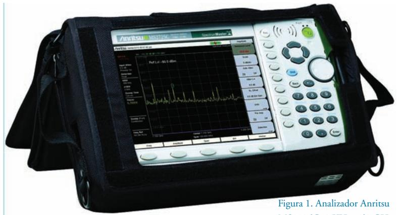
Figura 1. Analizador Anritsu MS2726C, 9 KHz a 43 GHz
