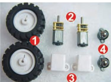
Figura 4. Elementos del equipo destinados a la tracción de Azkar-Bot. Dos ruedas de 42 x 19 mm (1), dos micromotores (2), dos soportes (3) y dos bolas de acero que evitan el cabeceo frontal y posterior (4).
