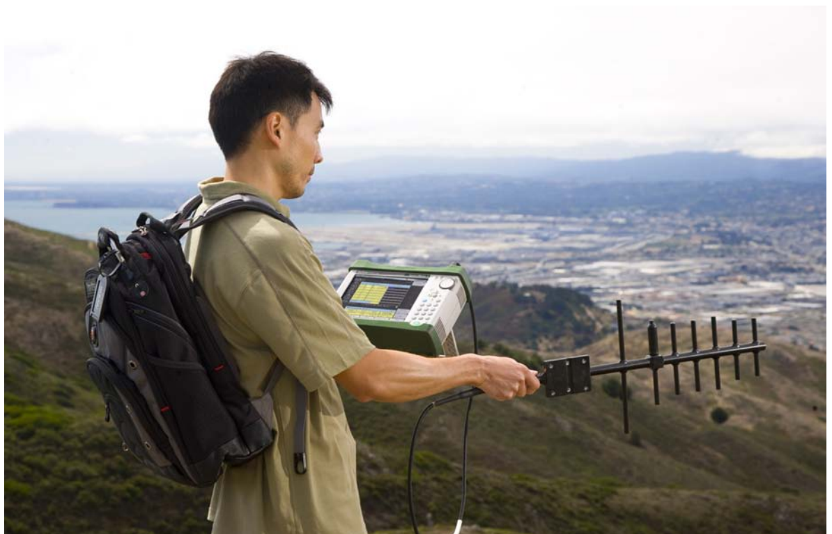
Fig. 5 Medidas EVM con una antena Yagi
