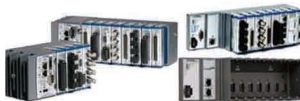
Figura 5. CompactRIO, CompactRIO integrado y chasis de expansión con Ethernet y determinista CompactRIO
