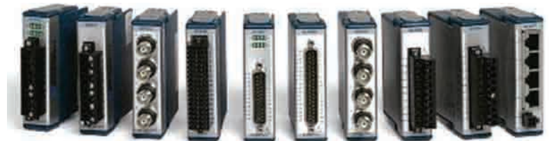
Figura 2. En los sistemas de NI RIO se puede elegir entre más de 50 módulos de E/S para conectarse a casi cualquier sensor o actuador.
