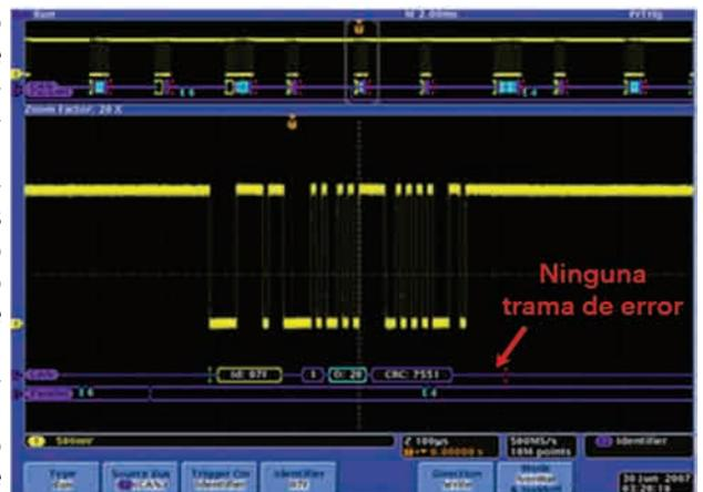
la Figura 4 se ilustra un ejemplo de trama de error en un paquete de bus serie CAN. Este osciloscopio tiene una velocidad de actualización de forma de onda muy elevada que no disminuye cuando se usa la función de decodificador serie. Comparado con éste, el osciloscopio de la Figura 5 tiene una velocidad de
