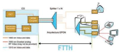
Este bucle de abonado totalmente óptico, desde la central hasta el hogar, se fundamenta en una red óptica pasiva, capaz de soportar velocidades superiores a 1 Gigabit, denominada GPON (Gigabit Passive Optical Network). Este tipo de arquitectura utiliza exclusivamente elementos pasivos para guiar la distribución ascendente y descendente del tráfico por la red, siendo el principal dispositivo el divisor óptico (conocido como splitter).
