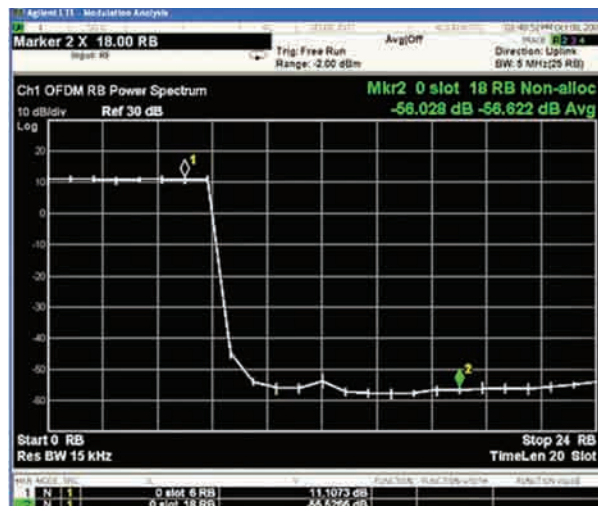
Figura 7. Medida de emisiones en banda para la prueba de bloques de recursos no asignados de una señal del enlace ascendente de 5 MHz.
