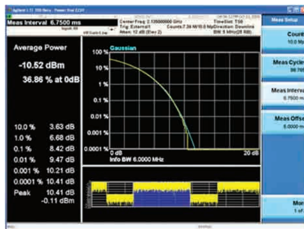
Figura 4. Medida típica de CCDF en una señal TDD.
