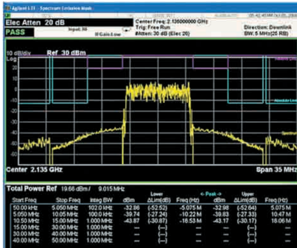
Figura 5. Medida de SEM con líneas límite establecidas para un transmisor completo.
