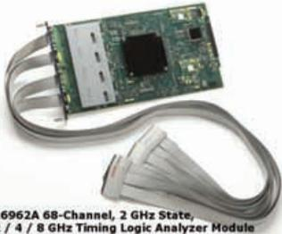
Las soluciones de prueba están constituidas por el módulo de análisis lógico 16962A de Agilent y una sonda mediadora NT-DDR3DIHS ó NT-DDR3SOIHS de Nexus para buses SDRAM DDR3 de doble tasa de transferencia de datos de próxima generación.
