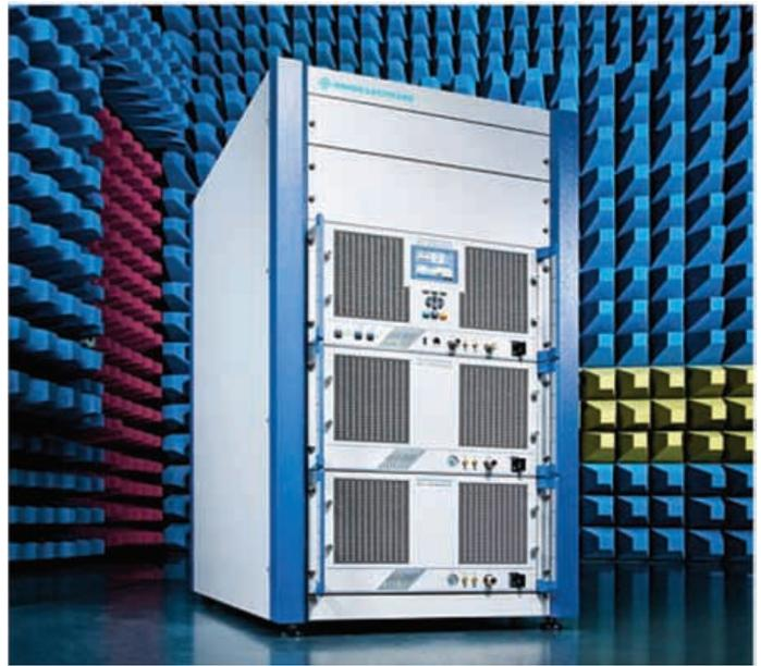
En su salida al Mercado, el amplificador dispondrá de tres bandas de frecuencia que cubrirán el rango de 9 kHz a 1 GHz y una potencia hasta 500 W. La unidad base incluye todas las funciones de control. El controlador integrado del sistema, por ejemplo, control a las bandas de frecuencia, conmuta los componentes del sistema y monitoriza el R&S BBA100.
