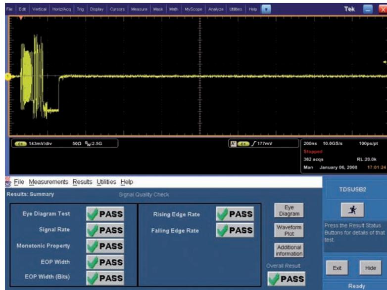
Figura 2. Informe sobre la calidad de la forma de onda y de la señal para un cable básico USB de 5 metros funcionando a alta velocidad.
