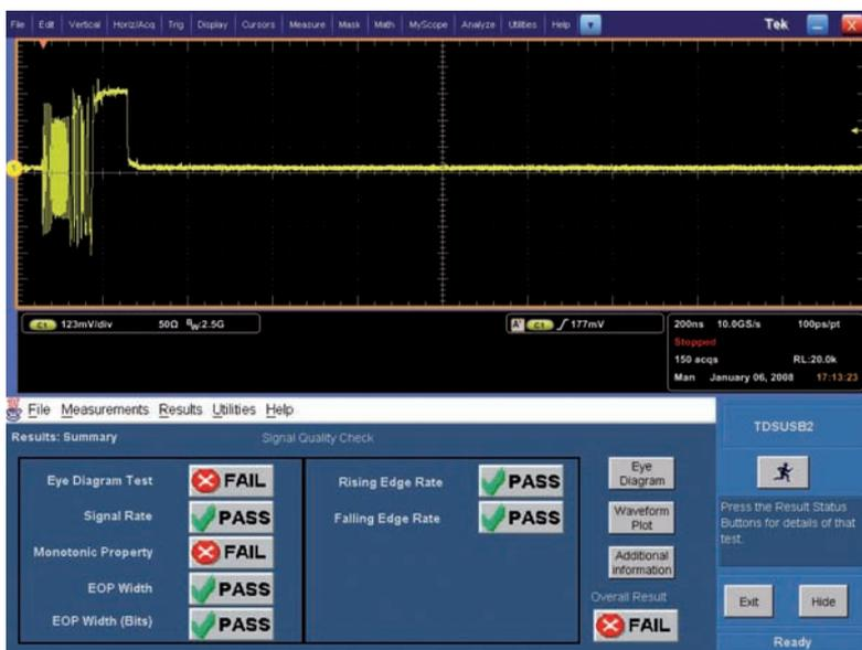
Figura 7. Diagrama de ojo de una señal USB de alta velocidad con 7,5 metros de cable.
