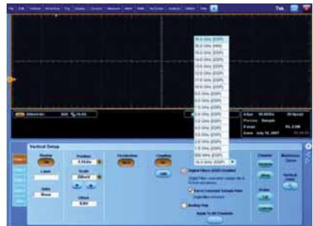
En el primer caso la respuesta estaba configurada solo para el modo analógico (sin DSP). Ahora vamos a examinar los diagramas de ojo utilizando el osciloscopio DSA71604 y la sonda P7516 de 16 GHz. Aunque el ojo está muy limpio, hay todavía una notable cantidad de ruido, algunos sobre-impulsos y algunas ondulaciones presentes en la señal adquirida (Figura 4).
