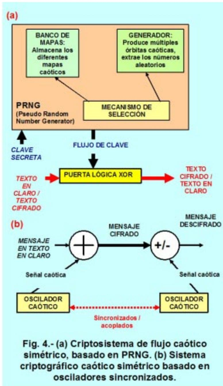
**Fig. 4.- (a) Criptosistema de flujo caótico simétrico, basado en PRNG. (b) Sistema criptográfico caótico simétrico basado en osciladores sincronizados.**
