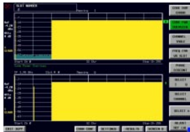
Figura 3. Señal HSUPA con cuatro canales E-DPDCHs
