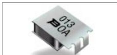
La naturaleza restaurable de una termoresistencia PTC ofrece ventajas significativas al equipo de telecomunicación. Las ondas transitorias, que tienen el potencial de desconectar un sistema si un fusible se funde, pueden reajustarse automáticamente con el uso de una termoresistencia PTC. La transformación desde un estado de baja resistencia a un estado de alta resistencia permite que la termoresistencia PTC limite las corrientes en casos de avería.
