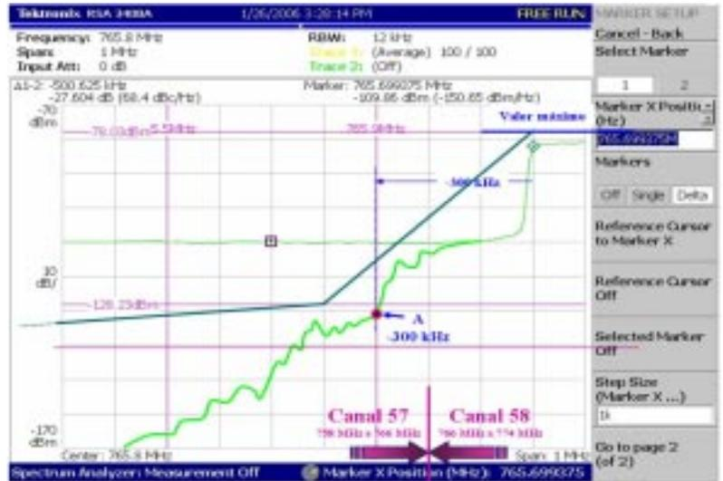
Figuras 18a y 18b. Simulación de medida de "hombros" indicando los puntos A y B a 300 y 700 kHz.
