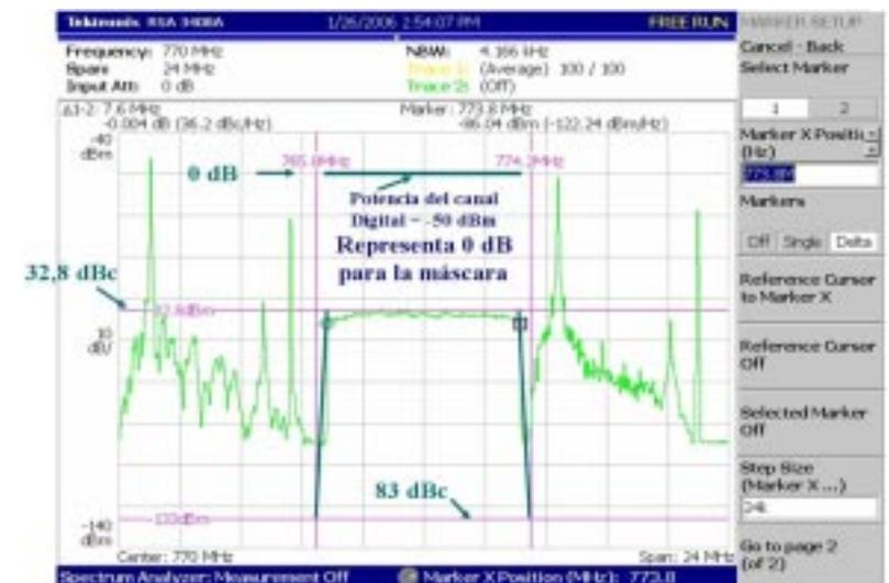
En la figura 15a se muestra la medida de nivel, es decir, de potencia media total, que en la señal recibida en este ejemplo es de unos -50 dBm. Debe advertirse aquí, que este ejemplo trata de simular las medidas a la salida de un transmisor donde la potencia total es, naturalmente muy superior, y que la única razón de hacerlo así es el hecho de no tener acceso a un transmisor real durante la elaboración del artículo.
