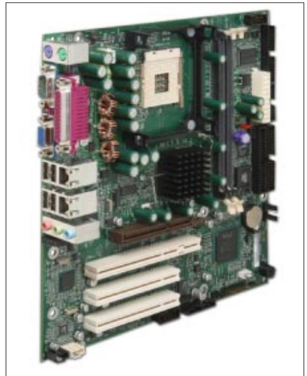
Figura 5: RadiSys BG845G Motherboard con opciones de LVDS y Ethernet (Cortesía: RadiSys Corporation)
