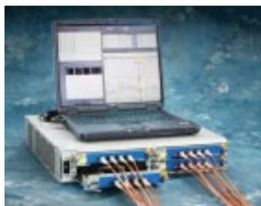
Figura 2. Tester SUN (chasis) con su controlador. Puede simular hasta 2000 componentes virtuales
