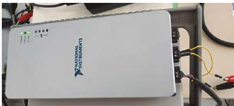
Figura 3. Conexión de las señales a la tarjeta de adquisición. Los cables dupont amarillos corresponden a la señal PPS, mientras que el cable negro (funda) transmite la señal eléctrica de la red.
