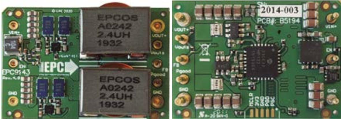
Figura 2. Diseño de referencia EPC9143 con un controlador DSP, top y bottom.
