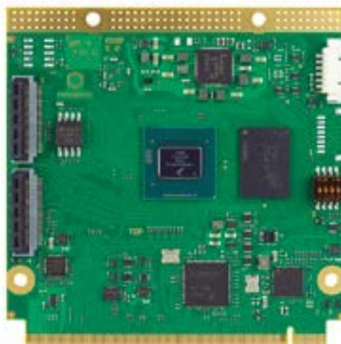
Figura 5. El módulo Qseven basado en la serie de procesadores NXP i.MX 8M Plus de 14nm ofrece procesadores ARM Cortex-A53 / M7 de cuatro núcleos, así como una unidad de procesamiento neuronal (NPU) integrada para inteligencia artificial, lo que lo convierte en una opción de actualización ideal para los futuros diseños de MTX-StarBMS. Pero para las necesidades actuales, el módulo Qseven con procesador i.MX6 es totalmente adecuado.
