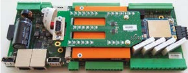
Figura 2. La última innovación de Matrix es el compacto MTX-StarBMS, un PC de carril DIN perfecto para los centros de control de automatización de edificios. (Fuente: Matrix)
