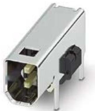
Figura 2. La toma modular SPE 1163797 de Phoenix Contact es compatible con todos los estándares SPE actuales. Tiene capacidad para suministrar hasta 72 voltios a 4 A. (Fuente de la imagen: Phoenix Contact).
