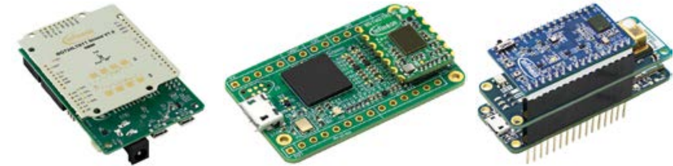
Figura 3. Los kits de desarrollo complementan a los radares: Distance2goL demo de 24 GHz (a la izquierda), MMIC BGT60TR13C demo (en el centro) y kit de sensor conectado de 60 GHz (a la derecha).
