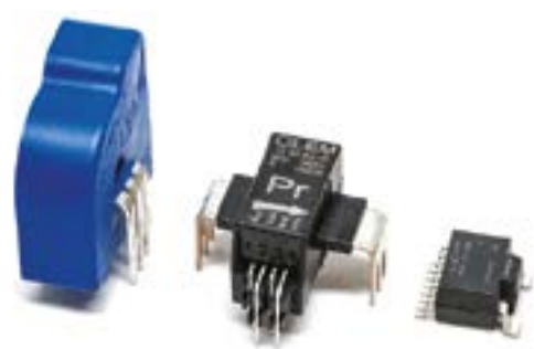
Figura 2. Miniaturización de la función de detección de corriente.
