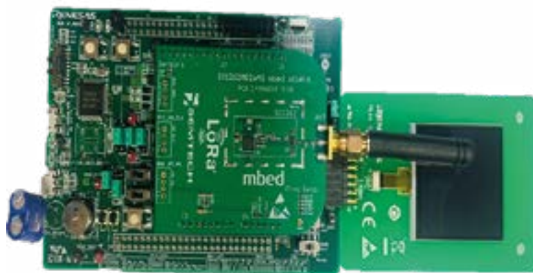
Figura 4. Placa de evaluación RE01-256K con la placa Arduino SX1261 LoRaWAN® y la placa de visualización MiPs.
