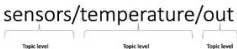
Figura 2. Temas MQTT (fuente: u-blox).
