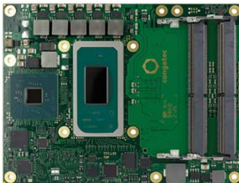
Figura 5. Los módulos COM Express clásicos con los procesadores Intel Core de 11.ª generación, por supuesto, todavía están disponibles.
