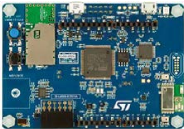
Figura 1. El B-L4S5I-IOT01A se basa en un procesador Arm Cortex-M4 que funciona hasta a 120 MHz con 2 Mbytes de memoria flash, 640 Kbytes de RAM, conectividad inalámbrica y múltiples sensores. (Fuente de la imagen: STMicroelectronics).
