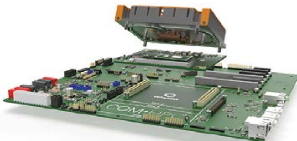
Figura 4. Listo para usar: el kit de inicio congatec con placa de soporte Eval y solución de disipación ya está disponible funcionalmente validado.
