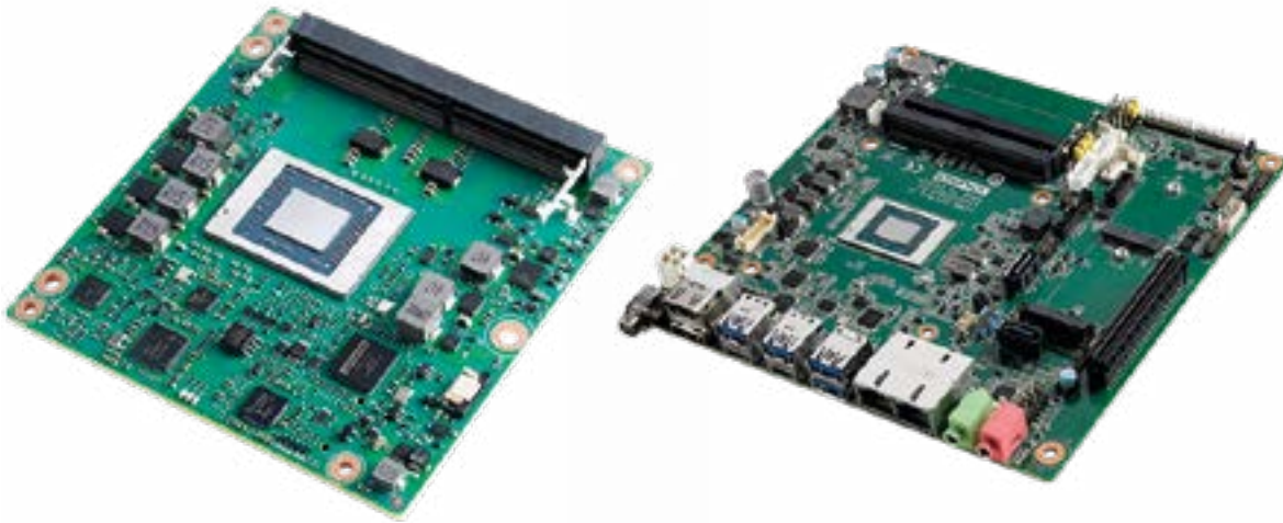
Los módulos SOM-6872 COM Express y AIMB-229 Mini-ITX están equipados con procesadores octa-core AMD Embedded Ryzen V2000 y pueden procesar un total de 16 hilos conductores en paralelo. Esta elevada capacidad de procesamiento en paralelo es crucial para los dispositivos edge.
