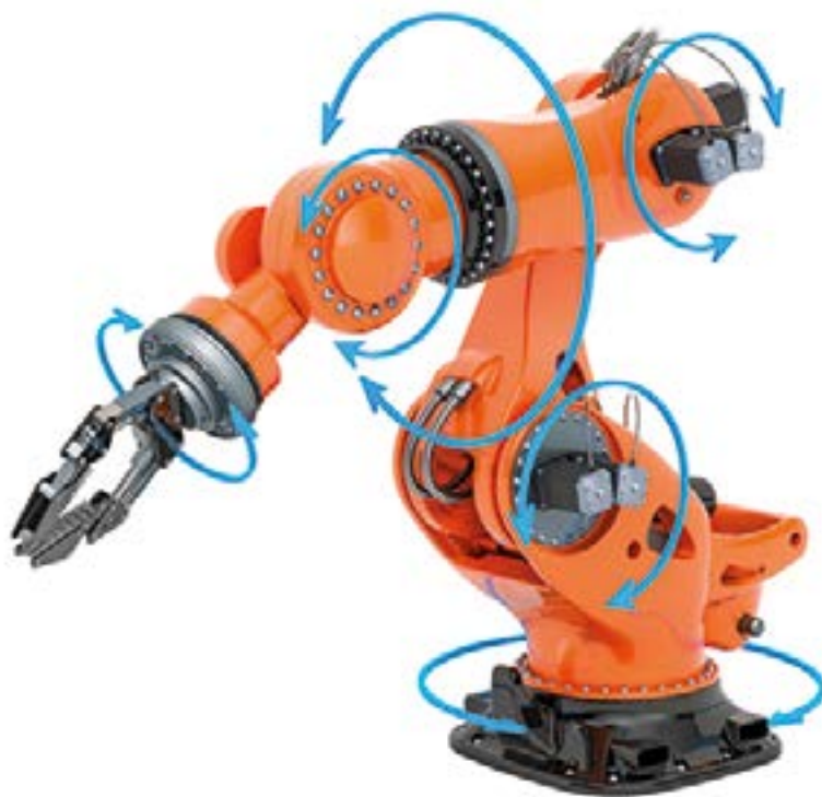
Imagen 2. El estándar de robot más complejo es la unidad de seis ejes, que imita el movimiento del brazo humano; la imagen muestra los seis ejes, cada uno con su motor, y las designaciones de estos ejes y del movimiento que crean [1] (fuente: natatravel/stock.adobe.com).
