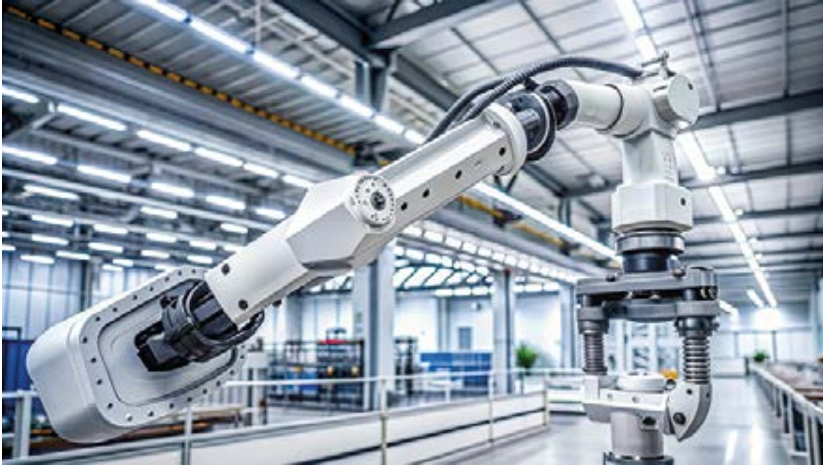
Imagen 6. Al analizar detenidamente el cableado de un robot en las unidades de seis ejes, queda claro que los cables deben gestionarse de manera independiente en cada sección (fuente: Four888/stock.adobe.com; generada con IA).
