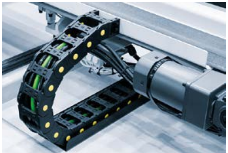
Imagen 5. El sistema portacables es más complejo que las opciones anteriores, pero añade protección y aporta otras características y ventajas, como las reparaciones individualizadas (fuente: Aleksandr Matveev/stock.adobe.com).
