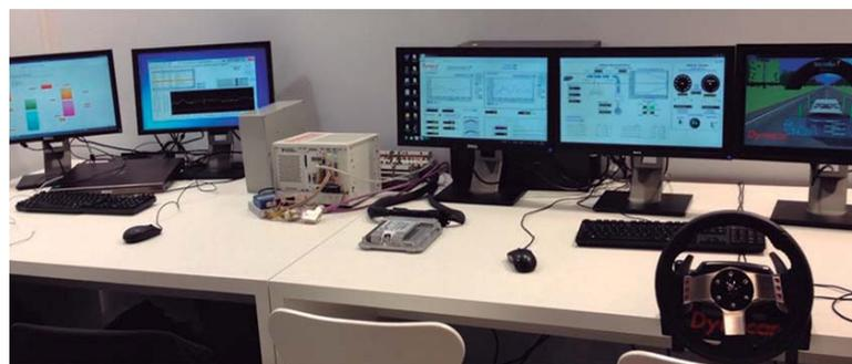
Banco de ensayos con los diferentes componentes. ECU bajo test y PXI de ECUs virtuales.
