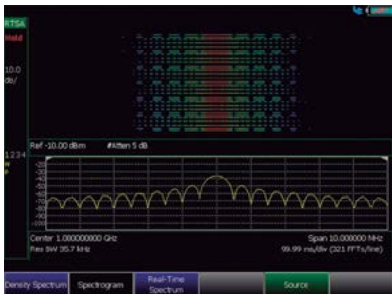
Figura 6. El espectrograma (arriba) utiliza una vista superior codificada por colores de los espectros de frecuencia respecto del tiempo (eje y) que revela pulsos a distintas anchuras, y cada visualización de espectro (abajo) permite al usuario ver los detalles en un instante específico.
