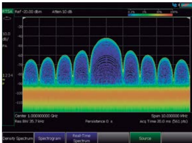
Figura 3. La pantalla de densidad con tiempo de persistencia seleccionado por el usuario resulta útil para comprender el comportamiento de múltiples señales que ocupan el mismo canal de frecuencia.
