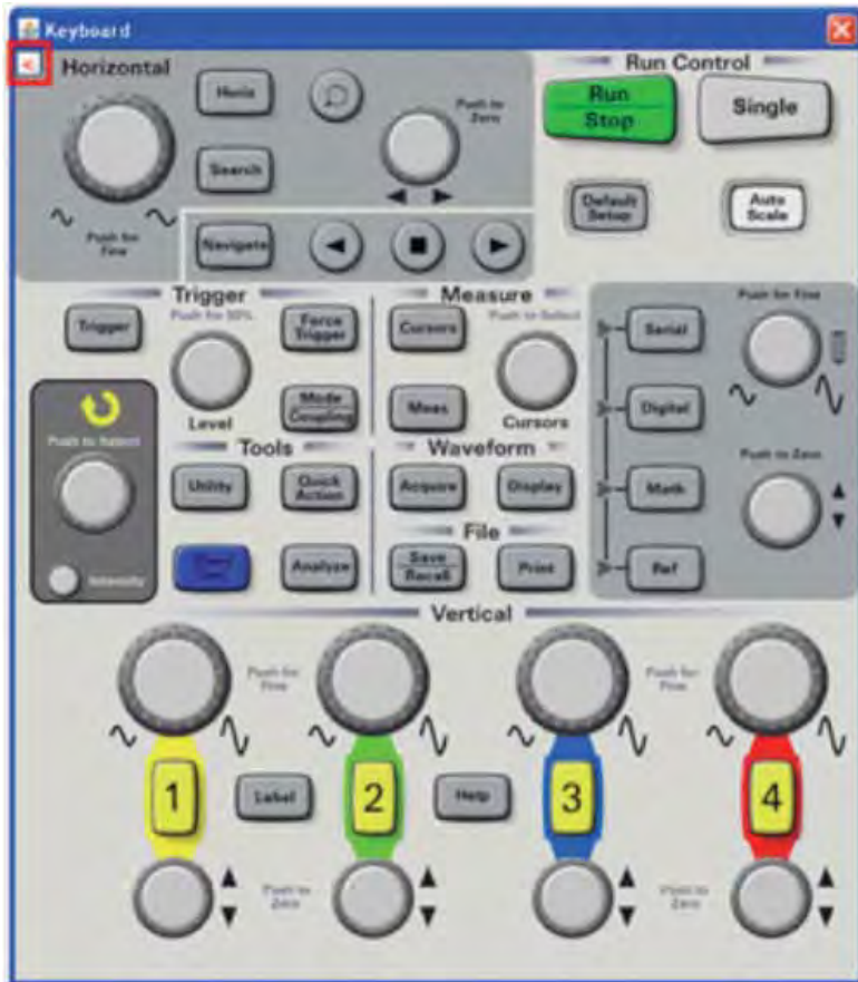
Figura 2. Vista del teclado desacoplado de la pantalla. La flecha resaltada de la esquina superior izquierda permite al usuario acoplar y desacoplar el teclado.
