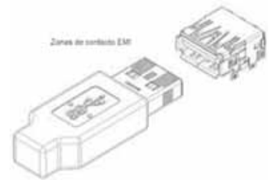
Figura 1. Conector estándar con nuevas zonas de contacto EMI (fuente: www.usb.org/developers/docs )
