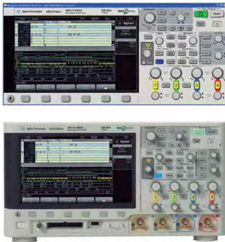
Figura 1. Arriba, un panel frontal de osciloscopio virtual y, abajo, el diseño real del panel frontal del nuevo osciloscopio InfiniiVision Serie X de Agilent.
