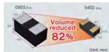
Fig 3 Diodo de barrera Schottky en comparación: 0603 vs 0402.
