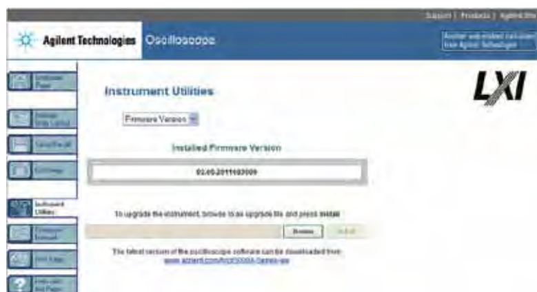
Figura 6. Esta ventana muestra la versión actual del firmware y una entrada de archivo para instalar una versión nueva.
