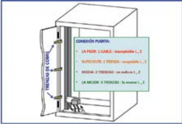
Figura 5. Niveles de conexión de la puerta a un armario industrial metálico con trenzas de cobre: 1, 2 o 3 trenzas. Las trenzas en paralelo reducen la inductancia de la conexión de la puerta, contribuyendo a la reducción de la impedancia. No usar cables. L: inductancia y Z: impedancia.
