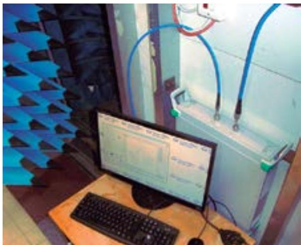
Figura 1. Instalación vertical del analizador de redes vectoriales cerca de la antena bajo prueba.
